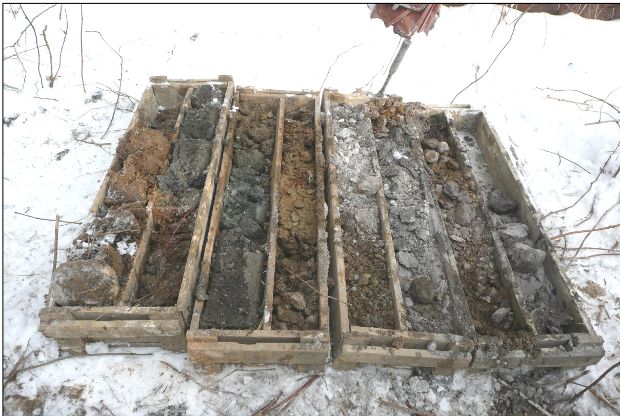
Foto č.18: Vrtné jádro průzkumného vrtu V5 (0,00-7,50m)
