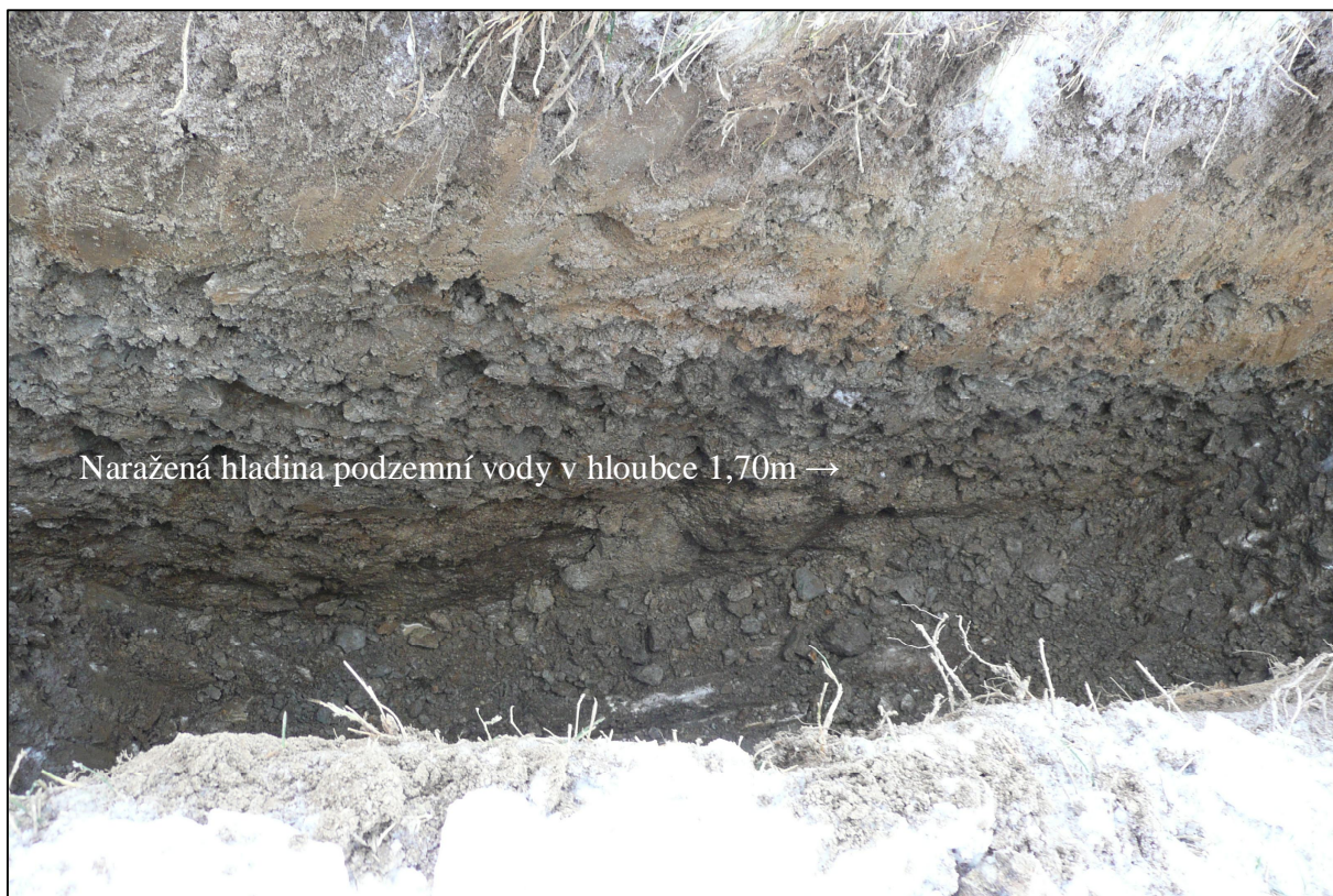
Foto č.13: Pohled na delší stranu vyhloubené průzkumné sondy K8
