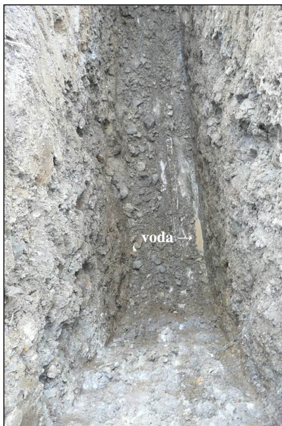
Foto č.12: Podzemní voda ve dně sondy K8
