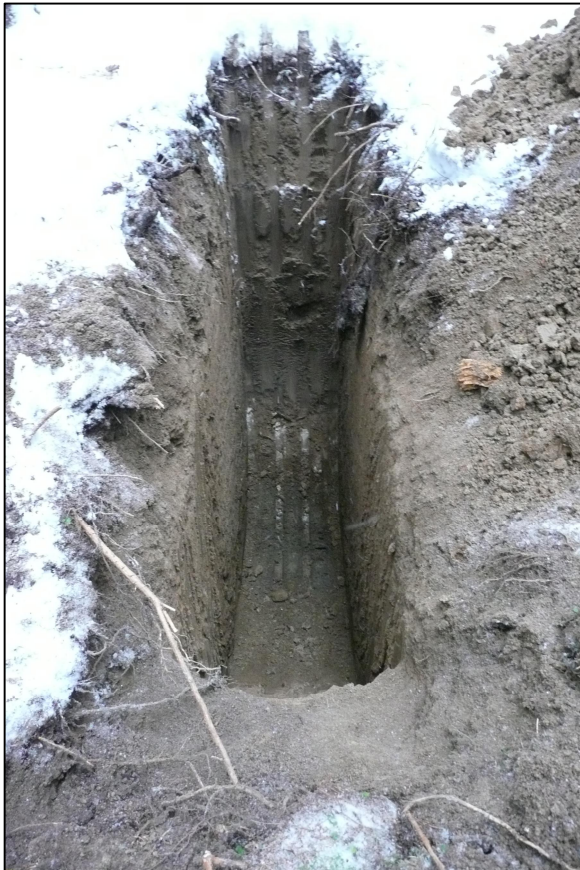
Foto č.7: Sonda K1 (0,00-3,00m)
