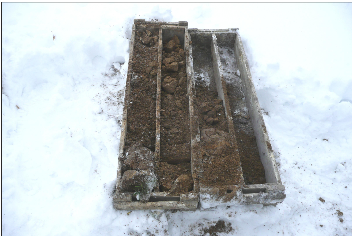
Foto č.15: Detailní pohled na vrtné jádro vrtu V3 (0,00-2,50m)
